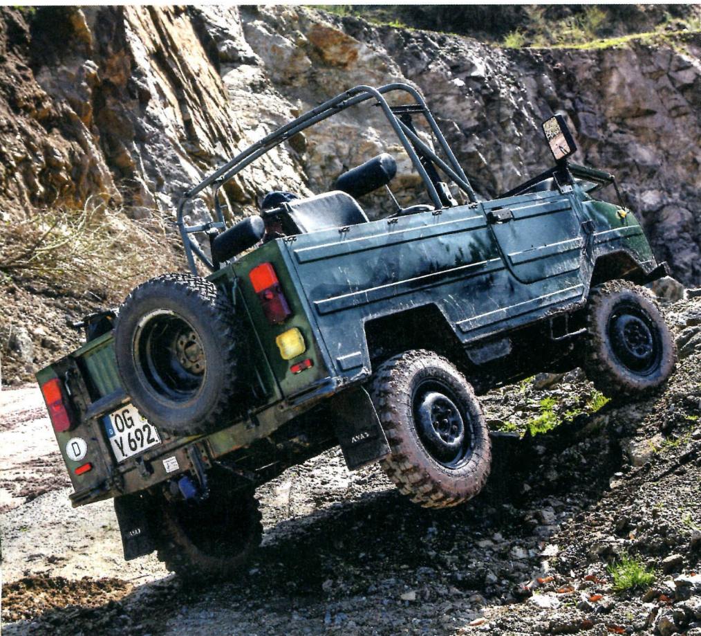
Dass er kein Verschränkungswunder ist, macht der LuAS mit geringem Gewicht (960 Kilo leer bei 0,4 Tonnen Zuladung!) und einem sperrbaren Hinterachsdifferential wieder wett
